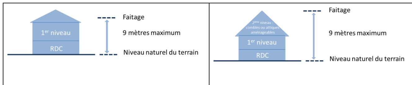
La hauteur des autres constructions principales est limitée à 9 mètres au faîtage.
