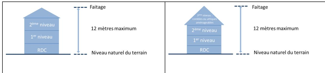
La hauteur des autres constructions principales est limitée à 12 mètres au faîtage.
