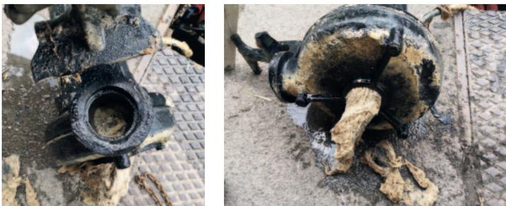
Les photos ci-dessus ont été prises sur le réseau du Val de Somme et montrent une pompe de relevage des eaux usées complètement obstruées par les lingettes jetées. Cela entraîne une difficulté de pompage, une surchauffe de la pompe qui va alors disjoncter, ce qui entraînera une montée en charge dans le réseau avec un débordement des eaux usées chez les particuliers ou dans les milieux naturels (rivière, cours d'eau, canal, ...).
